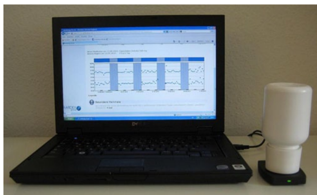
Abb. 3 Auslesen des elektronischen Beobachtungssystems MEMS°. Die im Deckel des Arzneimittelbehältnisses gespeicherten Compliance-daten werden mit Hilfe eines Lesegeräts und einer speziellen Software auf einen Computer übertragen. (Mit freundl. Genehmigung von Aardex)
